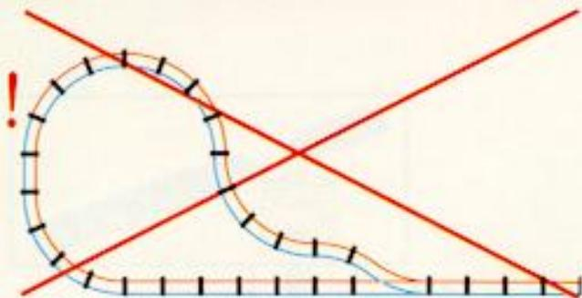
Einige Gleispläne, z.B. die oben abgebildeten, verursachen einen Kurzschluß. Wenn die Gleise kurzgeschlossen sind, schaltet sich die grüne Kontrollleuchte des LEGO-Fahrtreglers aus, bzw. leuchtet nur sehr schwach. Der Zug kann dann nicht fahren.
