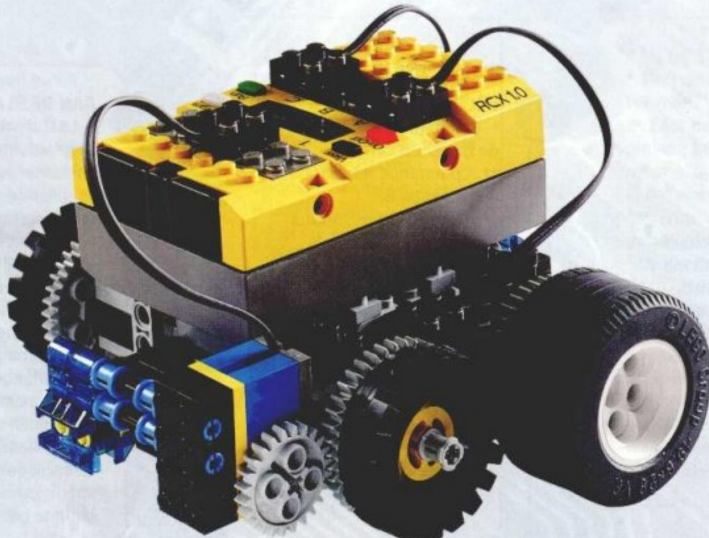
Dieses Programm weist den Roverbot mit angeschlossenem Robo Ruler an, 40 cm weit zu fahren. Das lässt sich auf der Testunterlage des Robotics Invention System 1.5 ganz einfach nachmessen. Wurde der Robo Ruler an ein anderes Modell angeschlossen, so muss eventuell der für den Rotation Sensor Watcher-Block angegebene Bereich (Zahlen) angepasst werden, damit der Roboter auch tatsächlich 40 cm weit fährt. Weitere Hilfen dazu gibt es auf Seite 17.
