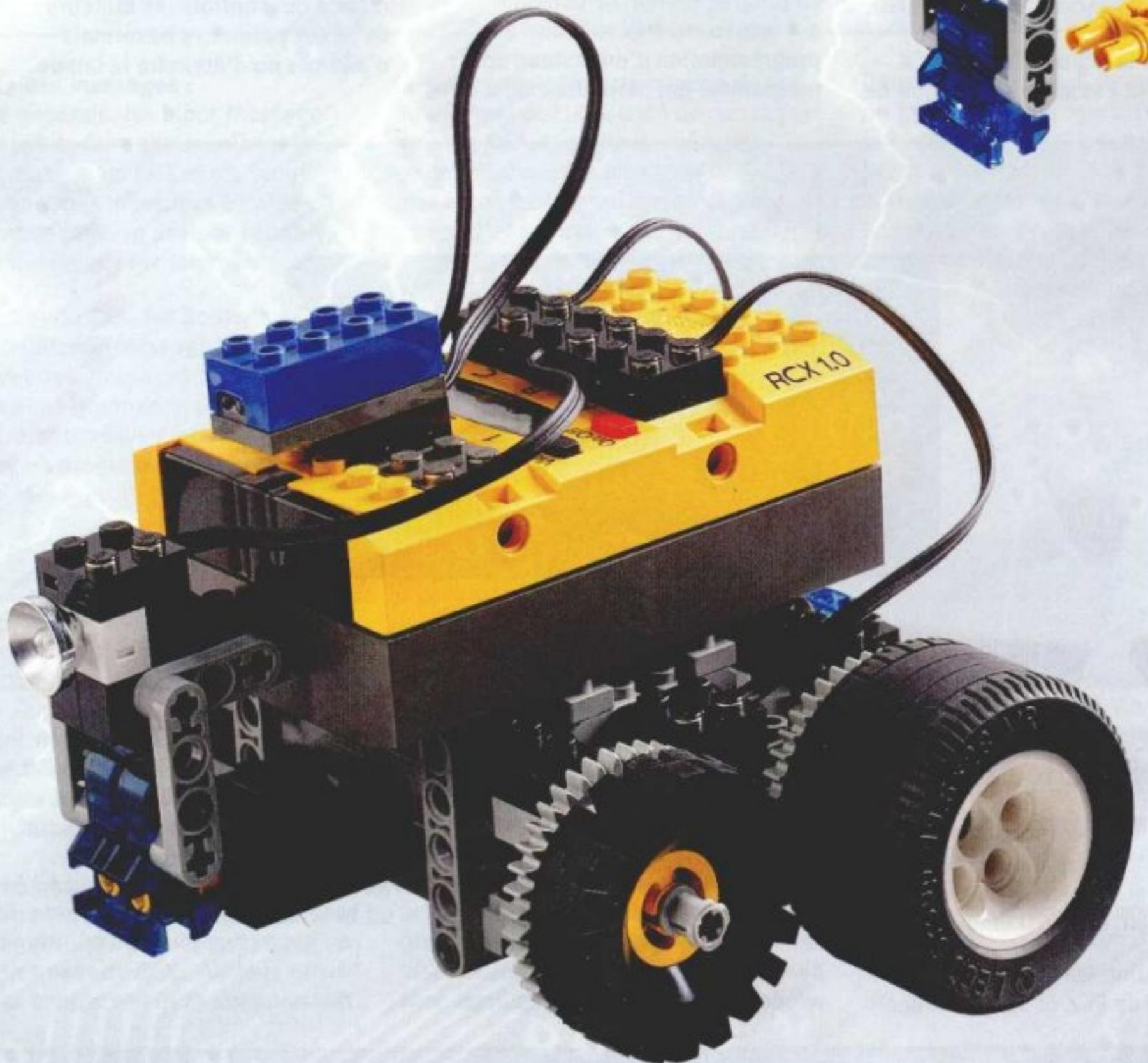
Mit diesem Programm funktioniert die Lampe wie ein Stoßfänger. Wie bei jedem Lichtsensorprogramm ist es auch hier wichtig, den Wertebereich (Zahlen) im Light Sensor Watcher-Block entsprechend der Raumbeleuchtung einzustellen.
